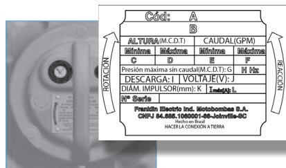
Figura 7 - Placa de identificación de la motobomba y sentido de rotación y reacción.
